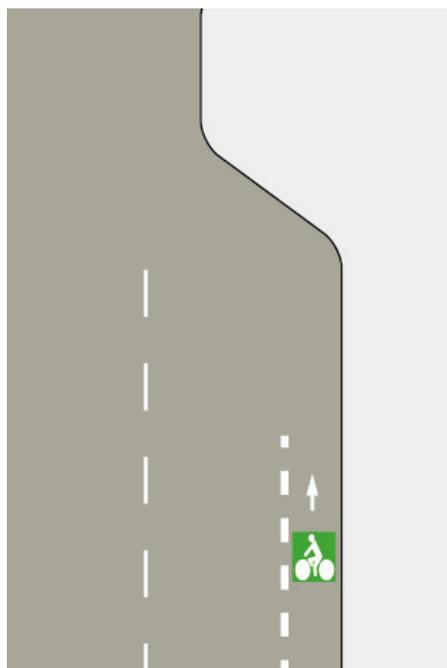
*Bande interrompue en amont d'un rétrécissement*
